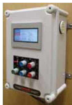
インバーター外部設定器 タッチパネルを使用して 簡単設定が可能
