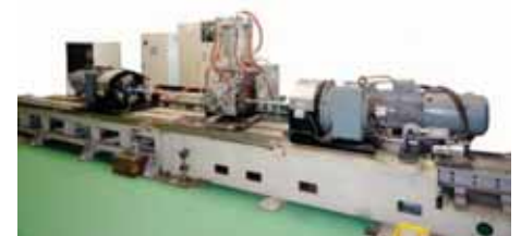
RMACREO装置例： (直径50mm×4000mmの処理が可能)
