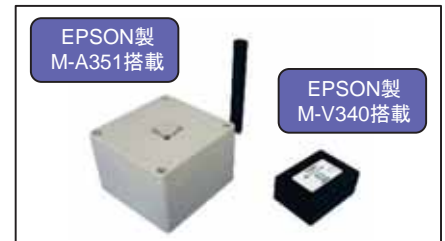
高精度ワイヤレス計測システム 3軸加速度センサー（左）、6軸IMU（右）
