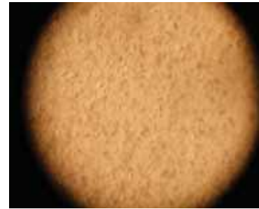
【未処理のアルミナと樹脂の混合物の表面】
